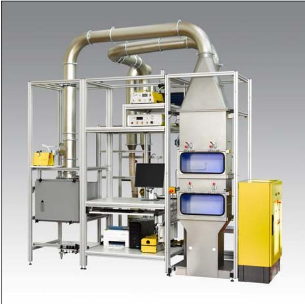
PAF 111 Kfz-Innenraumfilter-Prüfstand (Partikelfiltration)
