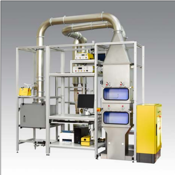
PAF 111 Kfz-Innenraumfilter-Prüfstand (Partikelfiltration)
