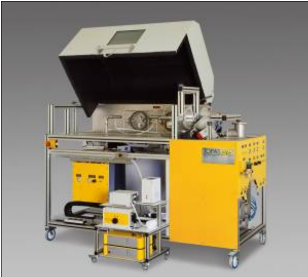
Blow-by-Abscheider-Prüfstand SPT 140 zum Testen von Ölnebelabscheidern
