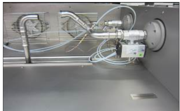
Beheizbarer Testraum (geöffnet) mit flexibler Aerosolzugabe; Rückwand mit Lüfter und Heizung
