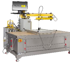
AFS152 mit großer Filteranströmeinheit 1830 × 915 mm
