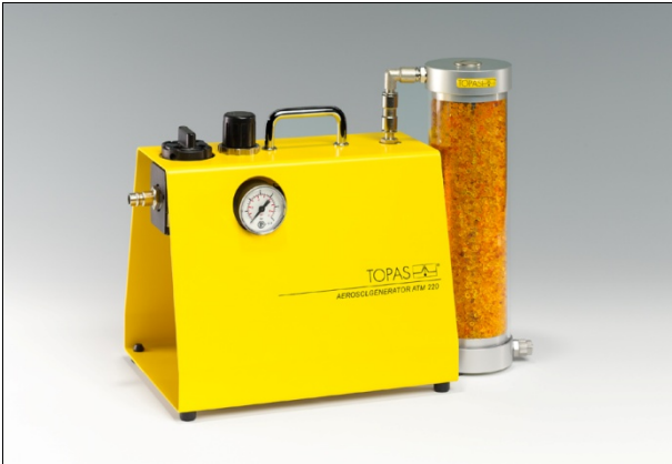
Atomizer Aerosol Generator ATM 220 (mit Diffusionstrockner), geeignet zur Erzeugung von Kalibrieraerosolen
