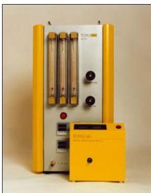
Monitoring des monodispersen SLG-Aerosols mit dem Prozess Aerosol Monitor PAM 510
