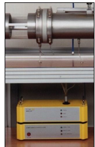
Effektive Ermittlung des Fraktionsabscheidegrades in Abhängigkeit von der Beladung (Anordnung mit Umschalteneinheit SYS 520 unterhalb eines Topas Filtermedien-Testkanals AFC 131)
