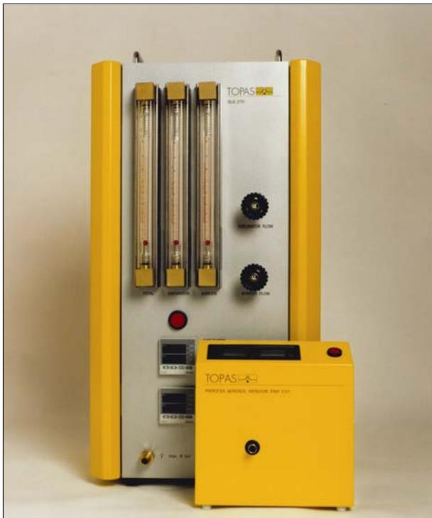
Monitoring des monodispersen Aerosols generiert vom Kondensations-Aerosolgenerator SLG 270 (Topas)
