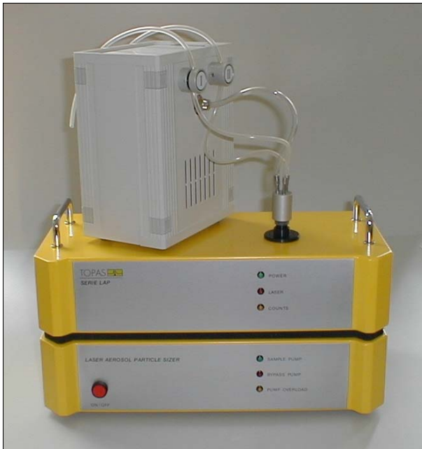
Probenahme-Umschalteinheit SYS 520, verbunden und schaltbar mit dem Laser-Aerosolspektrometer LAP 321/322
