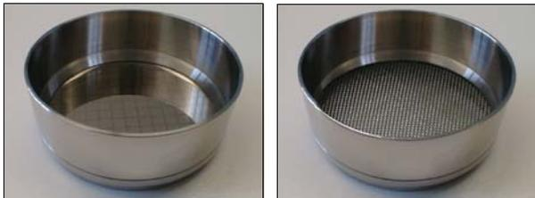
Feinstkornprüfsieb (links) und Gewebeprüfsieb (rechts)
