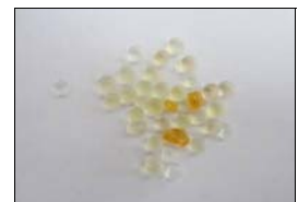
Silicagel ist beladen, Regenerierung erforderlich
