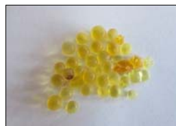
Trockenes Silicagel, gebrauchsfähig
