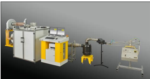
Prüfstand ABP 115 mit Wassereindüsung und Wasserabscheider
