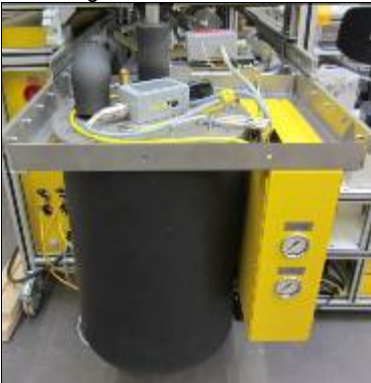
ATM 243 (mit druckfestem Gehäuse) im Prüfstand SPT 140
