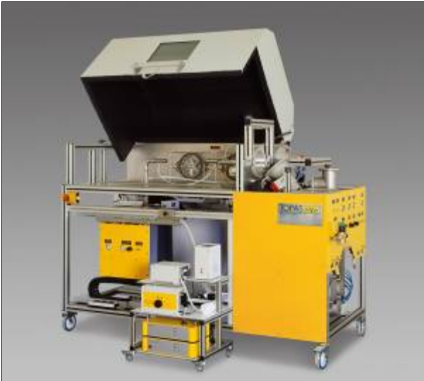
Blow-by-Abscheider-Prüfstand SPT 140 zum Testen von Ölnebelabscheidern
